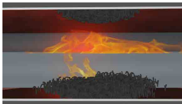
Bandage beginnt aufzuschäumen
